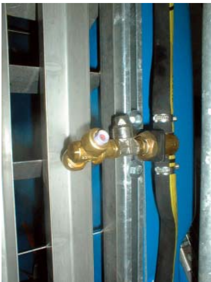
Abbildung 9: Doppeldüsenkörper mit Hohlkegeldüse
