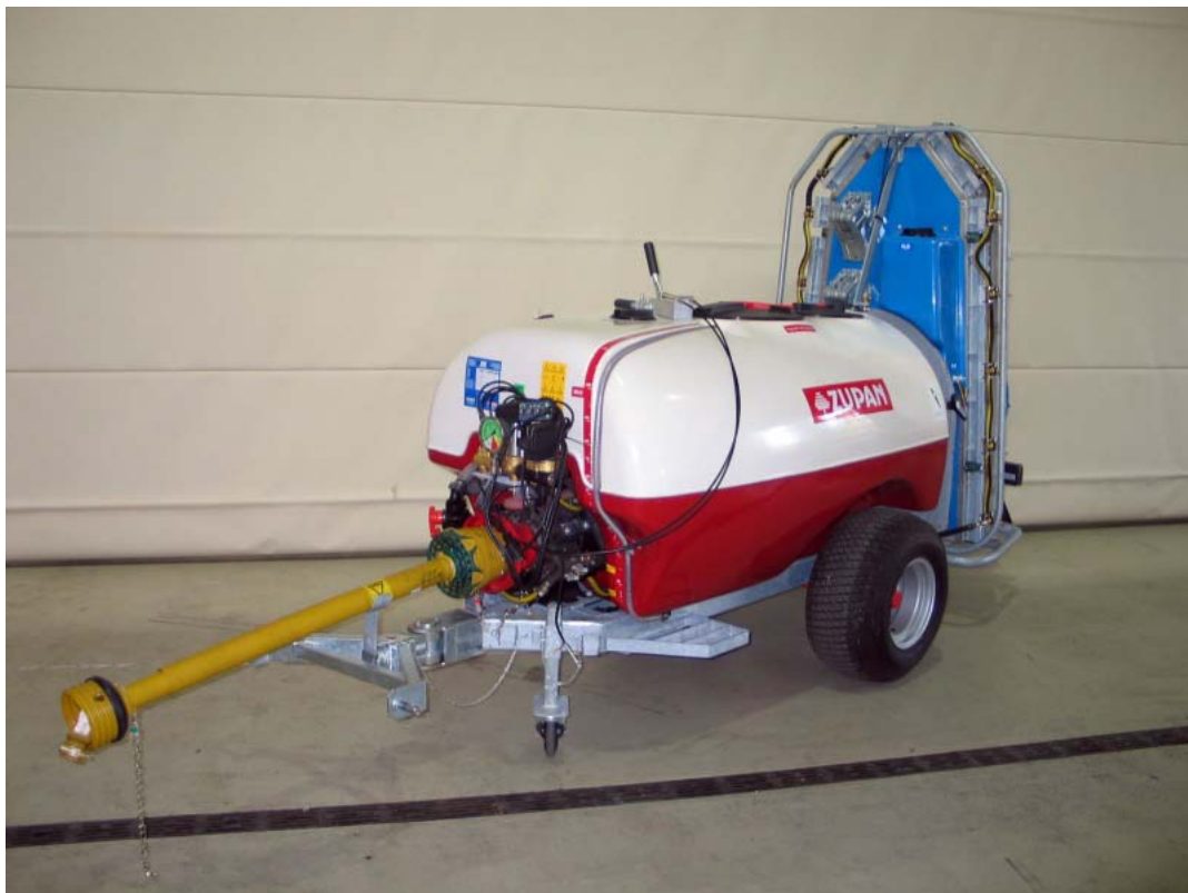
Anbausprühgerät Zupan ZM 1000 DTG mit Luftmengenregulierung
