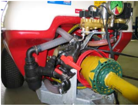
Abbildung 10: Saug- und Druckfilter im Bereich der Pumpe
